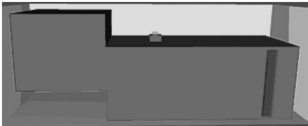
Слика 1. Изглед флешовер контејнера у програму „Пиросим“
