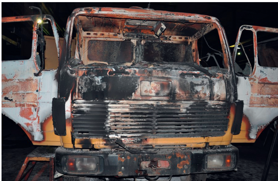
Фотографија 6. Изглед камиона када је пожар почео у кабини, а узрок је кратак спој на инсталацијама у пределу осигурача
