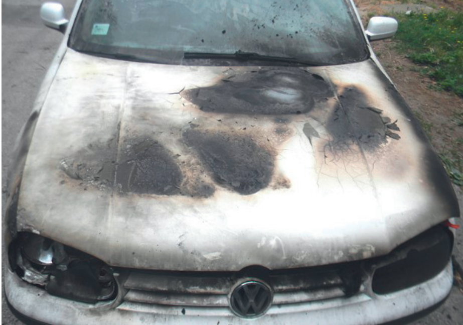
Фотографија 2. Печатно прегоривање на поклопцу мотора са спољашње стране
