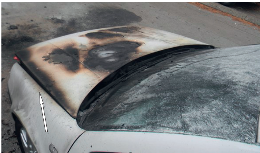
Фотографија 4. Димни ореол на ивици поклопца мотора
