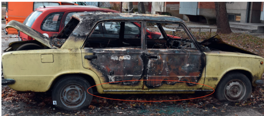
Фотографија 8. Изглед возила након самозапаљења централне конзоле унутар кабине
